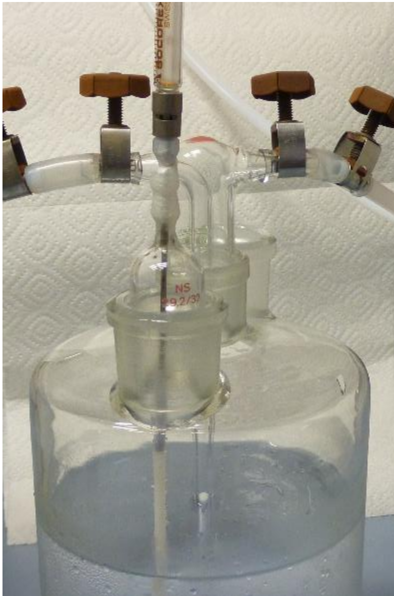
Abbildung 6: Ozonreaktor. In diesem Gefäß wird die Ozonstammlösung durch einblasen gasförmigen Ozons hergestellt. Mittels einer Glasspritze kann die Stammlösung quantitativ entnommen werden.
