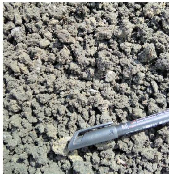
Figure 4 : Boues d'épuration utilisées comme matière première
