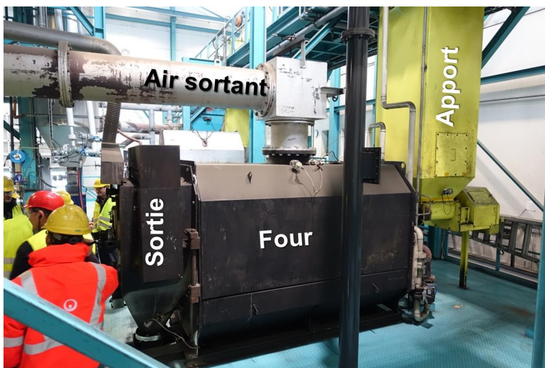
Figure 4. Four de réactivation de charbon actif de l'entreprise Batrec (photo: A. Joss, Eawag)
