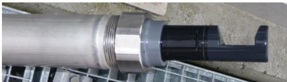
Figure 3. Plan rapproché de la fente de mesure d'une sonde CAS (photo: STEP de Reinach)
