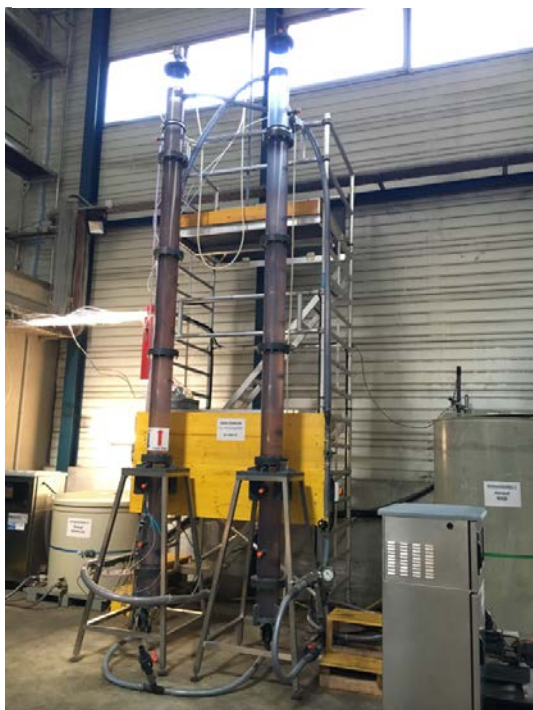
Illustration 5 - Installation pilote avec ozonation
