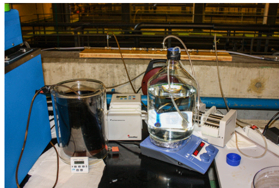
Ajout de la solution de ferrate (violette foncée) et de la solution de correction de pH (transparente) dans les mélangeurs statiques de l'installation pilote en arrière-plan.
