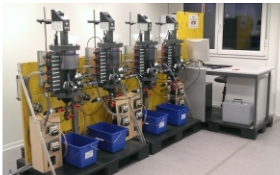
Réacteurs discontinus pour expérimentations (image: site internet)
