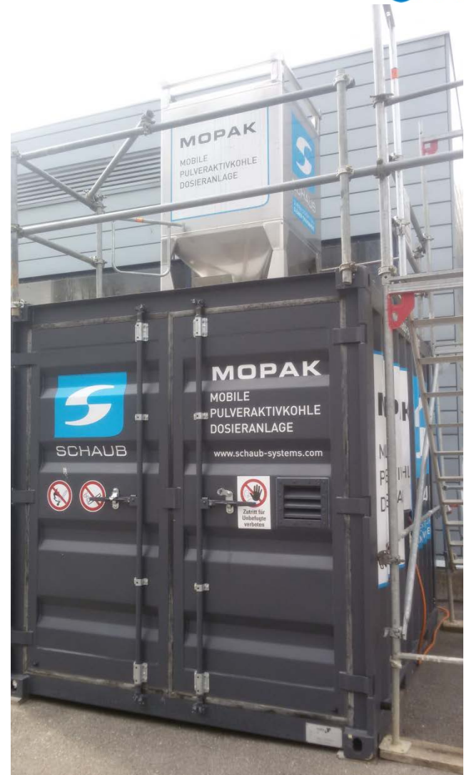
Dosieranlage Pilotversuch Fribourg
