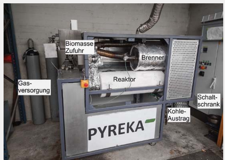
Fig. 1 PYREKA, eine Pilotanlage zur Herstellung pyrolytischer und aktivierter Kohlen aus Biomasse. Zur Pyrolyse wird der 1 m lange Reaktor permanent mit Stickstoff (2 l/min) durchströmt, zur Aktivierung mit 2–10 l/min Luft, CO 2 und/oder Dampf aus 1–7 ml/min destilliertem Wasser.
