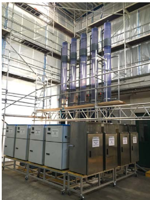
Abbildung 4 - Pilotanlage mit 5 GAK Kolonnen
