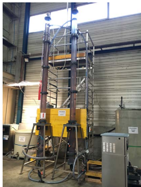
Abbildung 5 - Pilotanlage mit Ozonung
