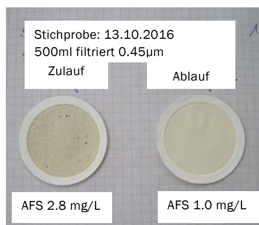
Abbildung 5.: Filterplättchen Zulauf (links) und Ablauf (rechts) der Tuchfiltration, ARA Lahr, inkl. Angabe AFS. Im Zulauf ist die Färbung deutlich dunkler als im Ablauf. Zudem sind in der Filter-Zulaufprobe auch einzelne Kohlepartikel erkennbar.
