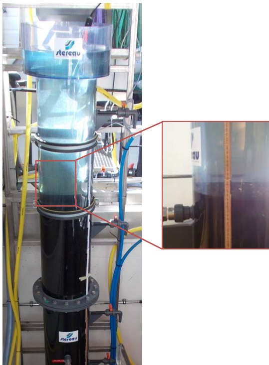
Abbildung 1: Pilotanlage für das CarboPlus®-Verfahren auf der ARA Penthaz: die Vergrößerung (Bild rechts) zeigt die klare Trennung zwischen Wasser und mikrogranulierter Aktivkohle (Abbildungen: Triform SA).
