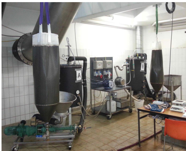
Abbildung 1: Foto der Faulungen A (ÜSS mit PAK) und B (ÜSS ohne PAK, Referenzfaulung) auf dem Klärwerk Mannheim und schematische Darstellung eines Faulbehälters [1]
