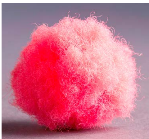
Abbildung 2. Fuzzy-Filter Medium: Synthetische Fasern, die zu einem Bällchen verwoben sind.
