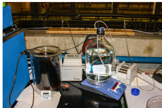
Zugabe der Ferratlösung (dunkelviolett) und der pH-Korrektur-Lösung (durchsichtig) in die statischen Mischer der Pilotanlage im Hintergrund.
