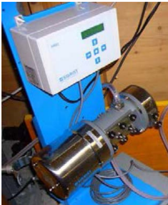
Abbildung 2: In den Versuchen eingesetztes Photometer der Firma Sigrist Photometer. (Bild: A. Wittmer, Eawag)
