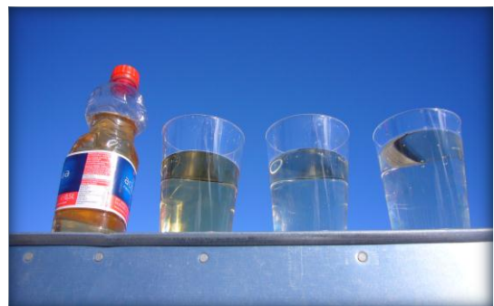
Abb. 1: Durch Ozon gereinigtes und entfärbtes Abwasser bei der Monte Rosa Hütte.
